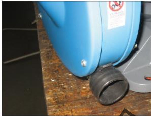
Фигура 8 – Извод на предпазителя за свързване към смукателна система
